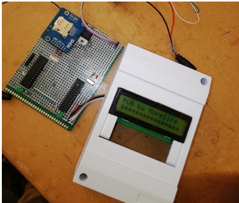
Рисунок Тестирование ПП счетчика воды и внутрисхемная отладка
