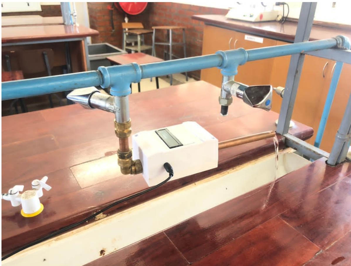
Рисунок. Испытания доработанного счетчика воды и подтверждение точности
